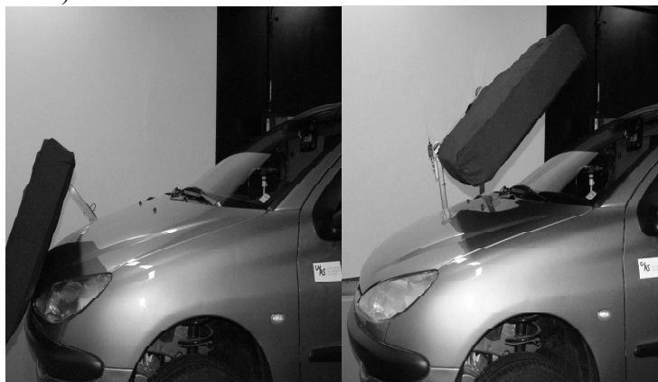
Figures 2. Système de propulsion du bloc de mousse : a) position en cours de trajet ; le bloc n'est pas visible - b) projection de la mousse venant heurter la pare-brise au moment de la collision.
