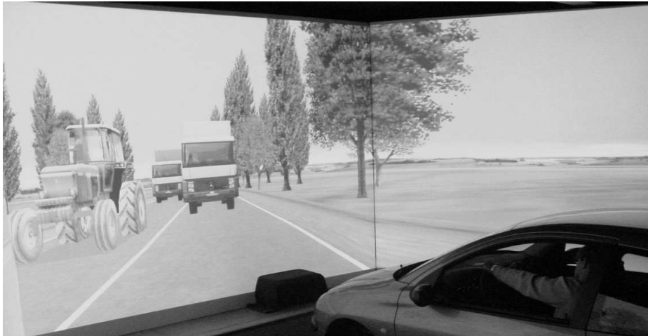
Figure 1. Simulateur de conduite SHERPA avec conducteur ; photo prise en phase de pré-crash.
