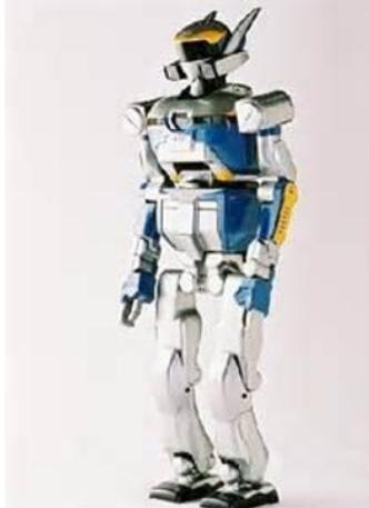
Ce robot humanoïde, de la famille HRQ, mesure 1m54 pour un poids de 58kg. Incapable d'agir en toute autonomie, il ne peut qu'obéir à une intervention de votre part. Ce robot peut réaliser une partie des tâches du quotidien, et sa capacité à communiquer lui permet d'échanger avec son environnement proche (humains et robots).
