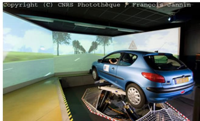
Figure 1. Le simulateur de conduite SHERPA
