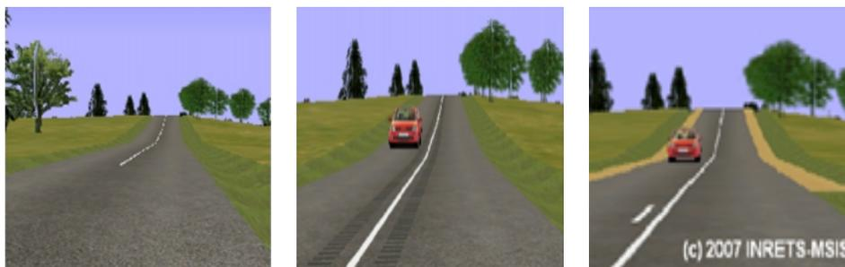
Figure 3. Caractéristiques visuelles du second sommet de côte ; de gauche à droite : référence sans aménagement, bandes d'alerte sonore, accotement revêtu.
